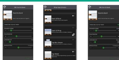
Es ist nicht mehr erforderlich, dass die Bediener Maschinenanpassungen für gängige Ladungsanwendungen (z. B. Stapeln & mit Band fixieren, Stapeln & Wickeln, Etiketten, Eckbretter, Deckfolie, oberer Karton, niedrige Ladungen) vornehmen, dank der Nutzung vordefinierter und doch anpassbarer Wickelprofileinstellungen.
