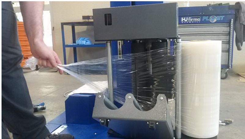
Phase 2-A: roller ein Folienende auf der Rolle aus Stahl, wie auf dem Bild ziehen.
